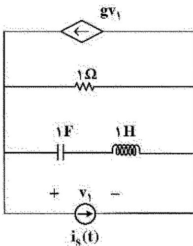
۲۳- اگر  $s=1$  فرکانس طبیعی مدار شکل زیر باشد، مقدار  $g$  کدام است؟
