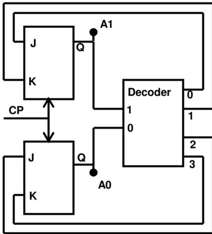
۱۱. برای مدار زیر، کدامیک از نمودارهای حالت صحیح می باشد؟
