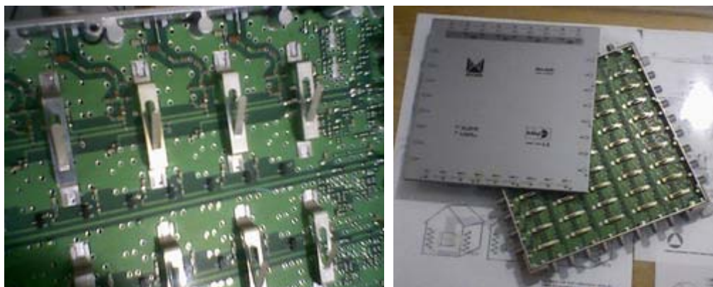
مدار چاپی مالتی سوئیچ آلكاد مدل MU 640
