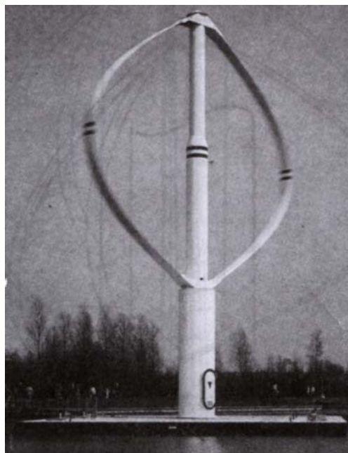
شکل - ۱۹ و ۲۰ توربین بادی با محور قائم مدل ساوونیوس با چها کابل مهار به زمین و توربین بادی با محور قائم مدل داریوس با دو پره [ ۶ ]
